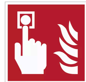
"Pulsante di allarme antincendio" - F005 Ref. 900428 ("Fire alarm call point")
