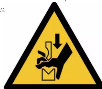
"Schiacciamento della mano nell'ingranaggio di una pressa piegatrice" - W030 50x50mm Ref. 900339 100x100mm Ref. 900338 ("Ecrasement de la main dans l'engrenage d'une presse machine à plier")
